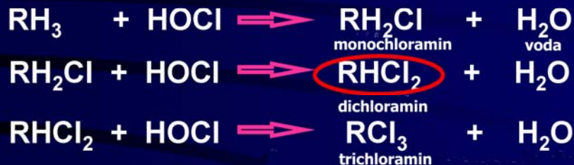
Obr. 5 Chloraminy jsou dusíkaté sloučeniny přírodního rázu nebo způsobené plavci, kteří do bazénové vody zanesou organické nečistoty (pot, kůže, moč) rozkládající se ve vodě biochemicky na:
