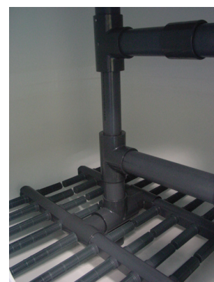
nedělené kolektorové trysky o průměru 50 mm snižují tlakové ztráty filtru
