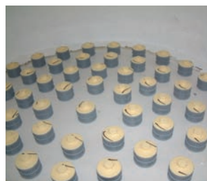
Detail falešného dna se vzduchovými tryskami
