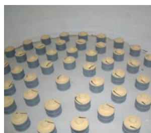
Detail falešného dna se vzduchovými tryskami
