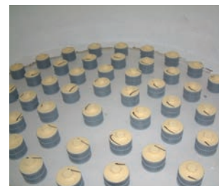
Detail falešného dna se vzduchovými tryskami
