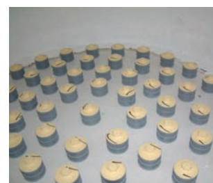
Detail falešného dna se vzduchovými tryskami
