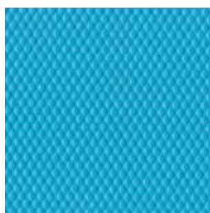
Reliéf protisklizového provedení fólie
